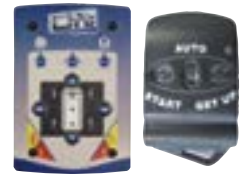
Bedienelement & Fernbedienung des Autolift mit 4 Hubstützen
