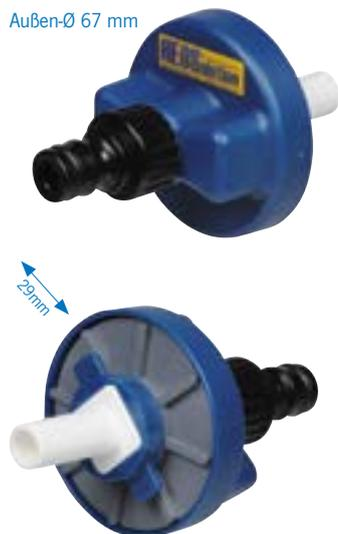
Für alle Tankeinfüllstutzen aus unserem Sortiment und von vielen anderen Herstellern. Durch 2 mitgelieferte Adapter kann der Wasser-Connector für diverse Einfüllstutzen verwendet werden. Mit Basisring für Deckel-Ø 77 mm oder mit Zusatzring für Deckel-Ø 67 mm. Auch für kleinere Einfüllstutzen, z. B. Dethleffs, LMC oder TEC ab Bj. 2010 geeignet. Für Wassertanks mit und ohne Überlauf geeignet.
