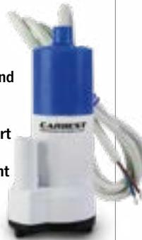
12 V, 0,6 bar, 5,0 A, Betriebszeit für 30 min, Förderhöhe bis zu 6 m, Trockendichtung mit Permanent-schmierung, Schlauchanschluss: Ø 12 mm / 1/2", Gewicht: 0,24 kg, Maße: H106 x B48 mm.
