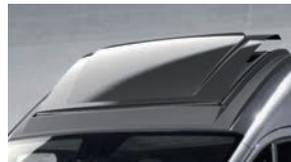
**Einbau:** Das Fenster ist ein vormontierter Bausatz und wird in den ausgeschnittenen Dach-Ausschnitt von 1270 x 660 mm mit geeignetem Kleber montiert.
