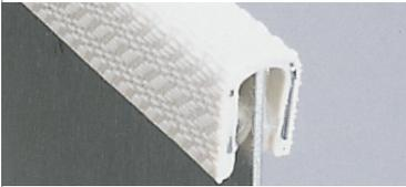
Beim Ausschneiden des Blechs beim Kastenwagen, um ein Fenster nachzurüsten, entsteht eine oftmals nicht sehr ansehnliche Schnittkante. Diese kann mit dem Kantenprofil verdeckt werden. Bitte nach dem Aufstecken prüfen, ob die Scheibe noch richtig eingeklebt werden kann. Klemmbereich 1,5-4,0 mm.
