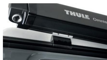
Die Markise wird mit den dazu bestellten Adaptern an der REIMO Multirail befestigt. Die Markise kann demontiert werden. Dabei verbleibt nur der untere Adapterteil am Fahrzeug, der auf dem Dach liegt.
