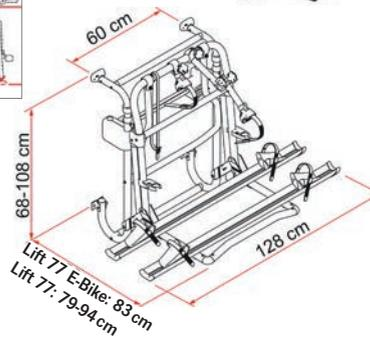
**Elektrischer Bike Lift mit 12 Volt Motor in 4 Varianten**
