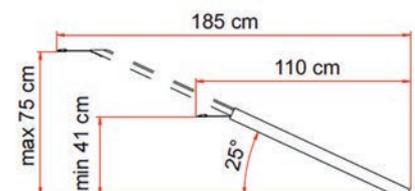
**Carry Ramp – 2 Schienen mit Antirutsch-Belag**
