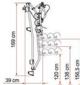
Montage des Auflagebügels in 3 mögliche Stellungen: Standard, Mittel und Abgesenkt. Variabler Abstand zum Boden je Fahrzeugkonfiguration.
