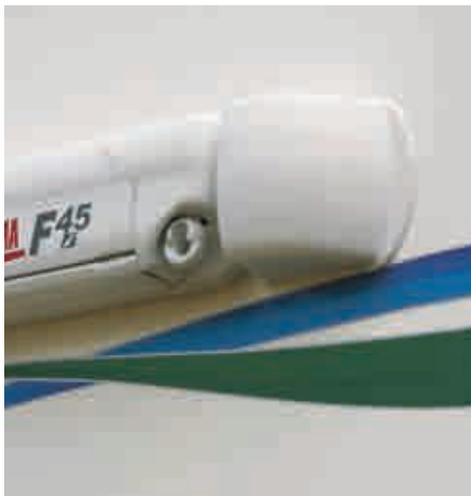
**Markisen-Spoiler** verbessert Luftwiderstand und Optik. Schutz vor Beschädigungen. Material ABS. Wird mit Sikaflex angeklebt. Für Markise F 45, F 45L und andere.
