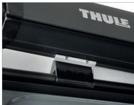
Die Markise wird mit dem mitgelieferten Adapter an der REIMO Multirail befestigt. Die Markise kann demontiert werden. Dabei verbleibt nur der untere Adapterteil am Fahrzeug, der auf dem Dach liegt.
