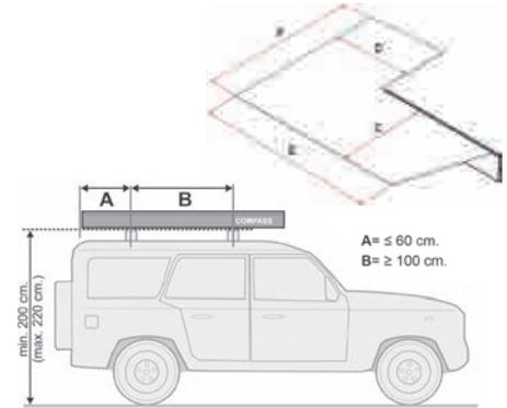
Bei ausgefahrener Markise kann die Öffnung der Heckklappe eingeschränkt sein.
