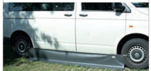
VW T5/T6 Seite, 250x42 cm. Befestigung mit Magneten und Seilspannung.
