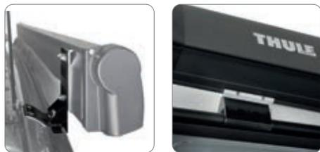
Die Markise wird mit dem mitgelieferten Adapter an der REIMO Multirail befestigt. Die Markise kann demontiert werden. Dabei verbleibt nur der untere Adapterteil am Fahrzeug, der auf dem Dach liegt.
