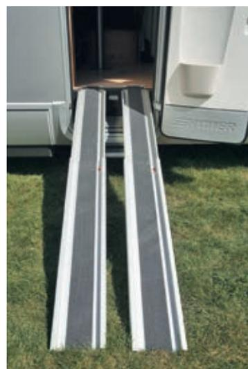
Zwei Carry-Ramp-Auffahrrampen ermöglichen das Einladen von Quads und Rollstühlen.
