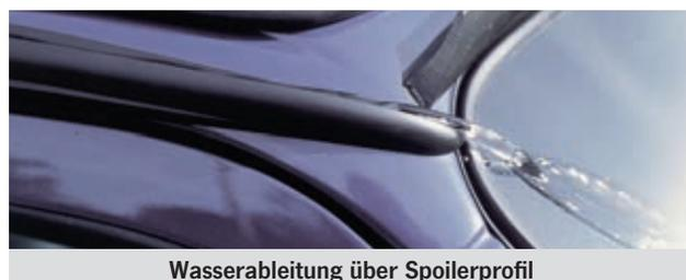
Wasserableitung über Spoilerprofil
