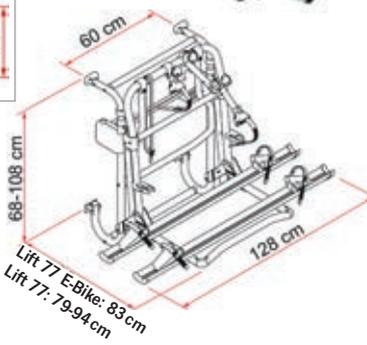
**Elektrischer Bike Lift mit 12 Volt Motor in 4 Varianten**
