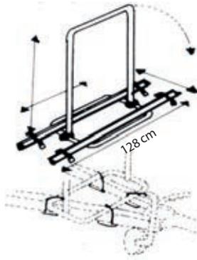
Geeignet für breitere und Standard-Deichseln sowie AL-KO Deichseln. Oberteil nach vorne schwenkbar, der Gaskasten ist somit leicht erreichbar. Stabiler Grundrahmen, gut abgepolsterter Fahrradhalterahmen. Fahrradschienen mit stabiler Riemenbefestigung für Felgen und Radrahmen.
