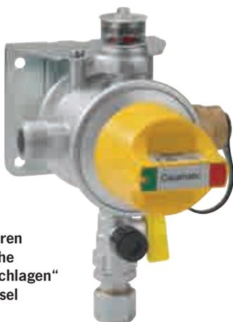
Automatisches Umschaltventil mit integriertem Niederdruckregler für die Zweiflaschenanlage, zum Anschluss an Gasflaschen mittels Hochdruck-Schlauchleitung, zur Druckregelung auf den Nenndruck des Gasgerätes. Konformität: EG-Baumusterprüfung nach GAR
