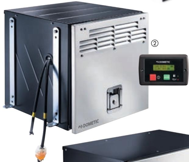
③ **Dometic TEC 40D – 3,5 kW** Kraftvoller Diesel-Generator für große Fahrzeuge. Gewicht 96,5kg, Hatz Dieselmotor, E-Starter, eingebauter Dieseltank erforderlich, Gehäuse aus Edelstahl. Autostart-Funktion z.B. zum automatischen Laden von Batterien. Elektronisch geregelte Frequenz (Sinuskurve).
