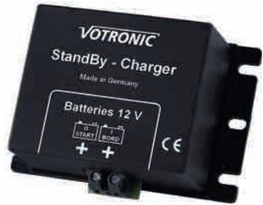
**Standby Charger** für Starter- oder Zusatzbatterien. Je nach Ladezustand der Wohnraumbatterie wird die Start- oder Zusatzbatterie automatisch mit einem Teil des Ladestroms mitgeladen. Überladung ist ausgeschlossen, da Ladespannung um 0,6 V reduziert und Ladestrom auf 2A begrenzt ist.
