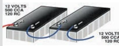
**Reihenschaltung von zwei 12 V-Batterien** (ergibt 24 V, Leistung bleibt gleich). Bei LKWs ist es sinnvoll, für den Wohnbereich zwei 12V-Batterien gleicher Leistung in Reihe zu schalten (24 V).
