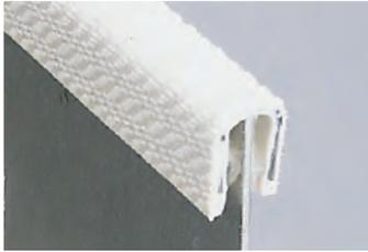
Beim Ausschneiden des Blechs beim Kastenwagen, um ein Fenster nachzurüsten, entsteht eine oftmals nicht sehr ansehnliche Schnittkante. Diese kann mit dem Kantenprofil verdeckt werden. Bitte nach dem Aufstecken prüfen, ob die Scheibe noch richtig eingeklebt werden kann.
