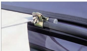
Die praktischste Lösung ist die Befestigung des Vorzelts am Fahrzeug mit Hilfe einer **Doppelkederstange**. Durch die Kederleiste sowie das Kederprofil kann das Vorzelt stehen bleiben, wenn das Fahrzeug weggefahren wird.
