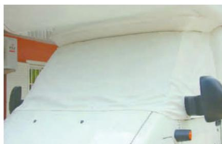
Einteilig für Fahrerhaus und Türen. Befestigung mit Laschen an den Türen und mit Haken am Türgriff. Lüftungöffnungen werden abgedeckt
