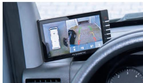
Vier Weitwinkel-Kameras – vorne, hinten, links und rechts installiert – beobachten das Geschehen rund um Ihr Fahrzeug und übertragen die Bilder auf den Monitor im Cockpit. Das intelligente Bildverarbeitungssystem führt die Daten zusammen und liefert Ihnen genau die Ansicht, die Sie gerade brauchen: Front, Seiten, Heck oder komplette 360° Rundumsicht. Die gewünschte Ansicht können Sie ganz einfach mit der mitgelieferten Fernbedienung aufrufen.
