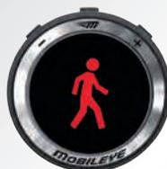
Fussgängerkollisionswarnung einschliesslich Fahrradfahrerererkennung
