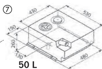
⑦ **EV 1111.** 50 Liter. DIN 96 Öffnung mit Verschlussring und Staubkappe für Tauchpumpe. Reinigungsöffnung 120 mm, 1 Zulaufstutzen 40 mm. 1/2" Entleerungsstutzen im Boden. 4 Befestigungspunkte. Aussparung an Querseite für Warmluftführung **61141<sup>1</sup> 90,85**
