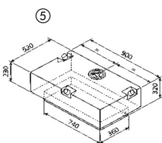
⑤ **EV 2201.** 124 Liter. Länge 900 mm. Absatz unten um z.B. Heizungsschläuche vorbei zu führen. **61104<sup>1</sup> 221,-**
