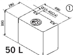
① **EV 1004.** 50 Liter. Keine Vorsprünge. 2 Anschlussstutzen für 40mm Schlauch. **61107<sup>1</sup> 78,75**
