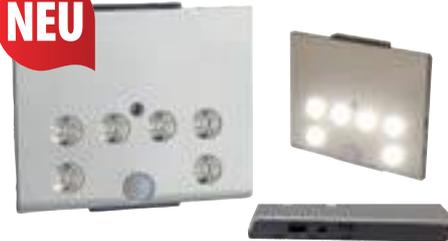
**LED Schrankleuchte, Akkubetrieb (1400mA)** Integr. Bewegungsmelder und Hauptschalter. Automatisches Abschalten nach 20 Sekunden. Mit Halteclip, zum einfachen Abnehmen der Leuchte. Via USB aufladbar. Ladekabel (60cm) anbei. Leuchtzeit ca. 9 Std., Ladezeit ca. 3 Std. LED-Leuchte 0,5 W. Maße: L102xB85xH10 mm. Energieeffizienz A+.
