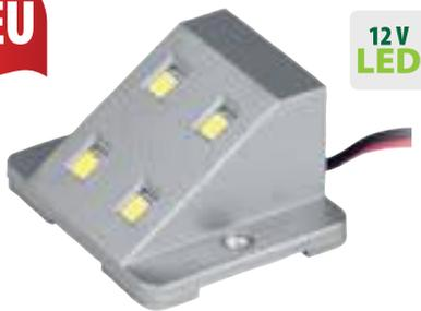
**LED Schrankleuchte mit Magnetkontakt.** Schaltet beim Öffnen der Schranktür ein. Fertiges Modul mit Gegenplatte für die Klappe oder Tür. LED-Leuchte 0,8 W. Maß: L30 x B30 x H19 mm. Energieeffizienz A+. 6000K. Farbe: silber.
