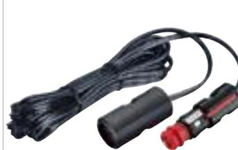
Kabel: 2 x 0,75 mm<sup>2</sup> Flachleitung. Länge: 4,0 m. Mit 8 A Sicherheits-Universalstecker & Universal-Kupplung (Innen Ø 21 mm), 12-24 V
