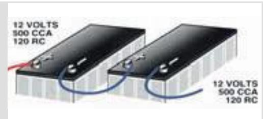
**Reihenschaltung von zwei 12 V-Batterien** (ergibt 24 V, Leistung bleibt gleich). Bei LKWs ist es sinnvoll, für den Wohnbereich zwei 12V-Batterien gleicher Leistung in Reihe zu schalten (24 V).
