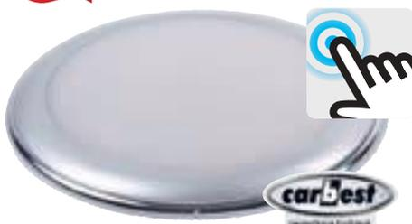
LED mit Touchschalter und umschaltbarem blauem Nachlicht. 36 warmweiße und 12 blaue LEDs. Kunststoff, chrom/silberfarben. 12V/5,5W. 3200K. 550lm, Abstrahlwinkel 120° Maße: ø 129mm, H 9mm. Energieeffizienz A+.
