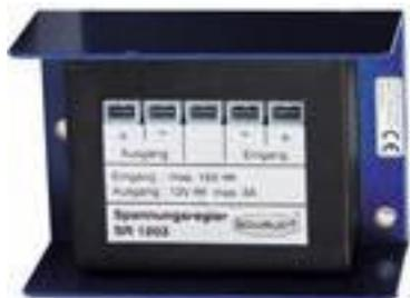
Der SR 1203 liefert eine stabilisierte 12-V-Ausgangsspannung für empfindliche elektrische Verbraucher, die exakt 12V benötigen. Eingangsspannung: 12 Volt bis maximal 15 Volt. Ausgangsspannung: 12 Volt (< 12 V bei Eingangsspannung < 13 V. Maximal zulässiger Laststrom: 3 Ampere. Maße: (LxBxH) 110x75x56mm. Gewicht: 140g. Inkl. Anschlussmaterial.
