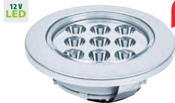
Einbauleuchte 9 SMD-LEDs, 1,5 Watt, 144 Lumen. ø 72 mm, H 25mm, Höhe Eingebaut: 6mm. Lichtfarbe 3200K, warmweiß. Gehäusefarbe: silber. Mit Klemmfedern. Lochbohrung für Einbau ø 52mm
