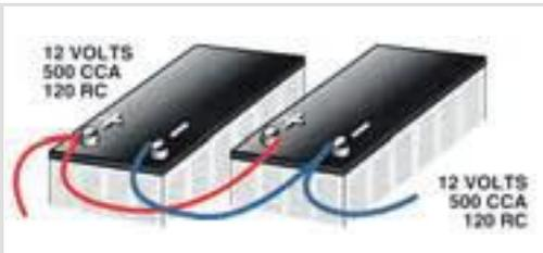
**Parallelschaltung von zwei 12 V-Batterien** (ergibt doppelte Leistung, 12 V bleibt gleich). Sie sollten jedoch nur Batterien gleichen Typs und gleicher Leistung parallel schalten!
