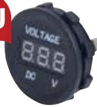
Universal-Voltmeter zum Einbau in das Kombimodulgehäuse. Digitalanzeige rot, 3-stellig. 10-30 Volt. Anzeige der anliegenden Stromstärke in Volt. Ideal zur Batterieüberwachung.
