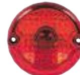
Ø Außen: 95 mm, Ø Einbauloch: 79 mm, Tiefe: 80mm, 12 V / 1x K21W, E1 1544, ca. 85 g
