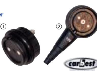
**Stecker und Buchse:** Max. 25 A. Anschluss Port: Flachstecker 6,3 mm, Anschluss Clip: schraubbar. Einbaumaße: Ø 28 mm, T 25 mm.
