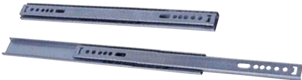
Schubladenführungen nicht aushängbar große Auszugslänge und Schubladenbreite, Führung ist einfräsbar; bis 12 kg belastbar, kugelgelagert. 278 mm, Paar 53382 1 9,99 342 mm, Paar 53383 50 8,40
