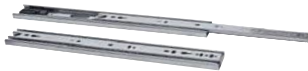
Schubladenauszug nicht aushängbar Stahl verzinkt, kugelgelagert. Aushängbar durch Trennhebel, mit Rückhaltesicherung zur Arretierung in geschlossener Position, bis 35 kg belastbar. Mit Selbsteinzug (nicht für Pushlocks geeignet) 400 mm, Paar 53387 10 20,99
