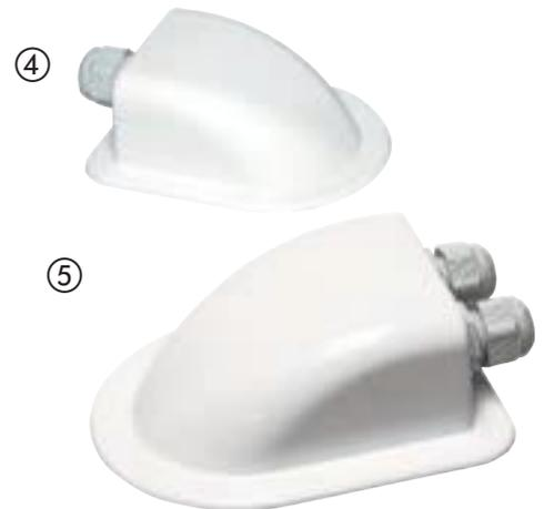
Sichere Durchführung von Kabeln durch Dach und Wand. Zum Aufkleben mit Sikaflex, inkl. Kabelverschraubung PG 13,5 für Kabel Ø von 6-12 mm.
