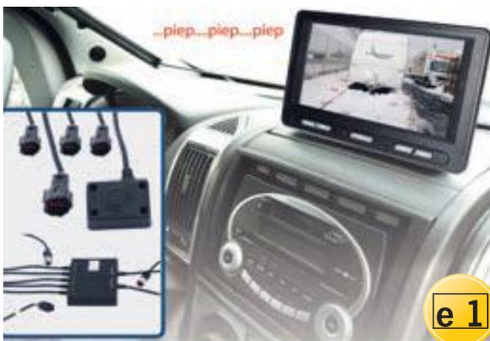
**Zusätzliches Ultraschall Warnsystem mit Entfernungsanzeige zur Ergänzung für noch mehr Sicherheit beim Rangieren.**
