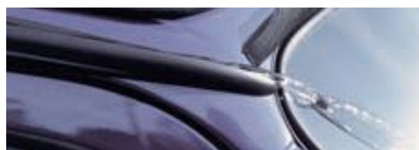
Wasserableitung über Spoilerprofil
