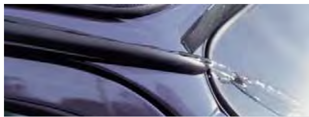
Wasserableitung über Spoilerprofil
