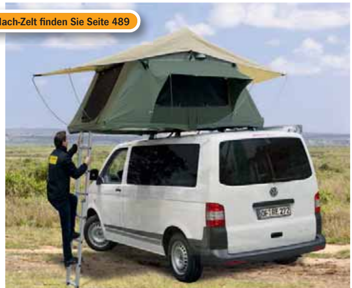
Zelteinstieg mit Aluleiter. An allen Öffnungen Moskitonetze
