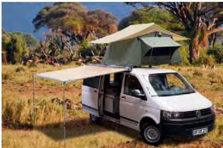
Zelt ist auch mit einer zusätzlichen Markise zu benutzen. Markise an Beifahrerseite mit passendem Adapter montieren
