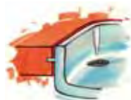
Dichten und Kleben von Spülbecken: Sikaflex 221
