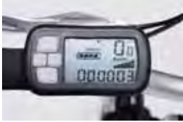
LCD-Display beleuchtet mit Anzeige Ladestatus, Geschwindigkeit, km-Stand und Antriebsmodus
