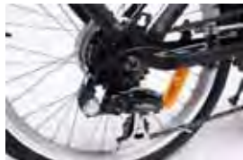
Heckmotor 250 W 6 Unterstützungsstufen wählbar
